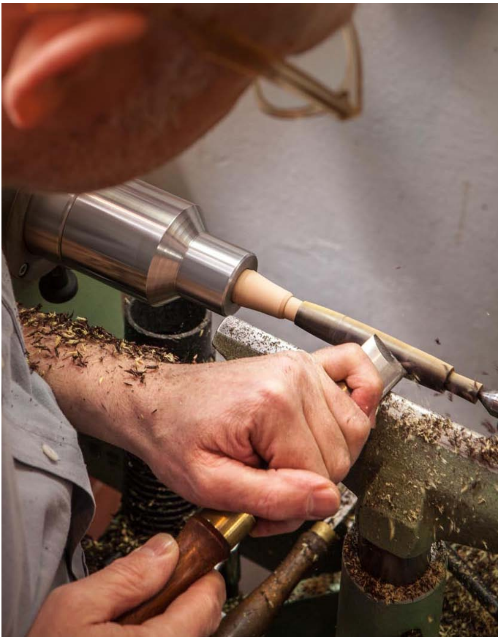
Millimeterarbeit. Links: Frei Hand drehselt der Meister einen Rohling in die endgültige Form. Oben: ganz persönlicher Flair am Arbeitsplatz. Darunter: Die Schwabbelstleibe verleiht dem „Schreibgerät“ einen edlen Glanz.
