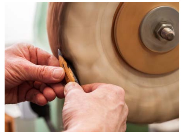
Millimeterarbeit. Links: Frei Hand drehselt der Meister einen Rohling in die endgültige Form. Oben: ganz persönlicher Flair am Arbeitsplatz. Darunter: Die Schwabbelstleibe verleiht dem „Schreibgerät“ einen edlen Glanz.
