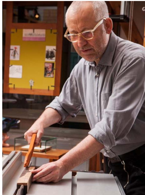
Der Füllermacher in seiner Manufaktur. Mit der Kreissäge schneidet der Drechsler und Tischler das Holz in rechteckige Kanteln. Stefan Fink gibt seinen Schöpfungen die Namen von Vögeln, wie „Kauz“, „Nachtigall“, „Albatros“.
